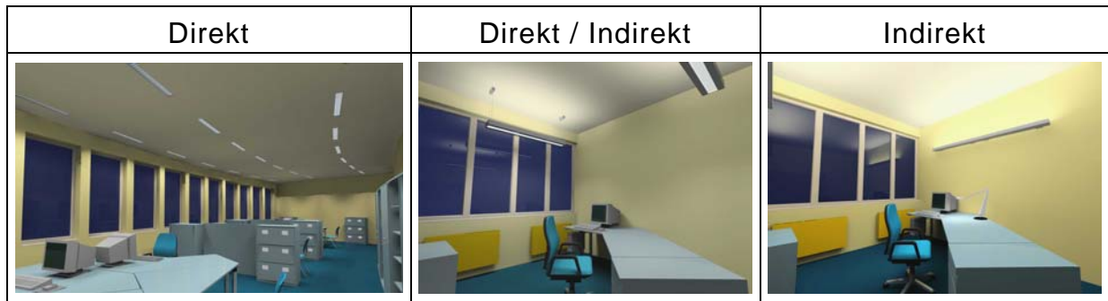
Bild 12: Die DIN V 18599-4 unterscheidet im einfachen Tabellenverfahren die Beleuchtungsarten „Direkt“, „Direkt/Indirekt“ und „Indirekt“.
